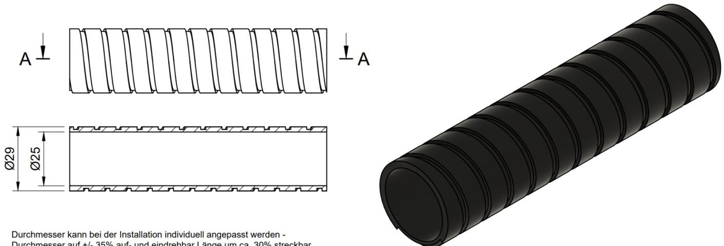
Durchmesser kann bei der Installation individuell angepasst werden -
